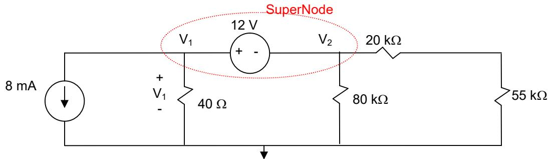
Use SuperNode technique ( $V_1$  &  $V_2$ ):
