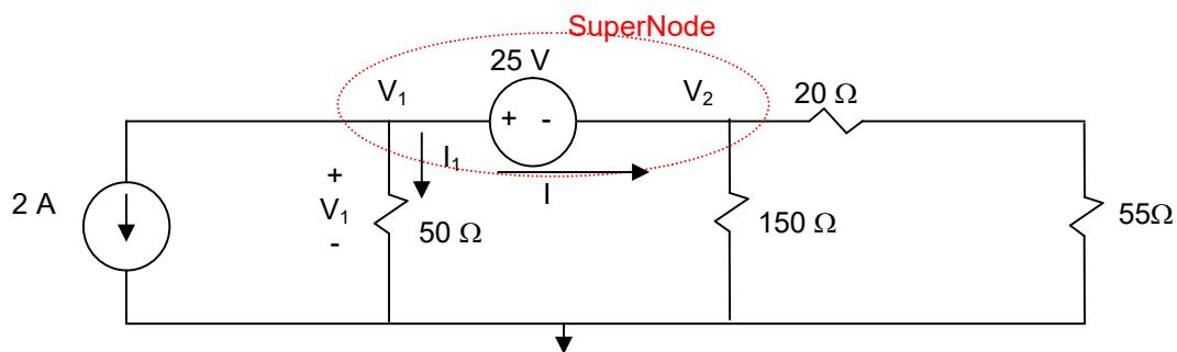
Use SuperNode technique ( $V_1$  &  $V_2$ ):
